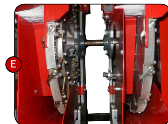
Е. Высевающие диски и система захвата семян, обеспечивающие точность и аккуратность посадки.
