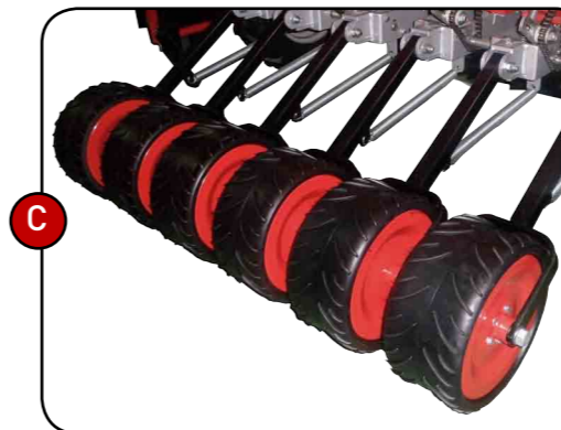
C. Compactación del bulbo.
